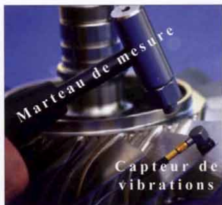
Fig. 2 : Mesure des vibrations par sonnage
