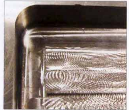
Fig. 5 : Vibrations liées aux dimensions des outils
